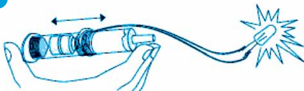
اکنون سرنگ را در دست بگیرید و آن را تکان دهید. آهنرباها آزادانه حرکت رفت و برگشتی می‌کنند. میدان مغناطیسی متغیر در پیچ‌های جریان تولید می‌کند و LED روشن می‌شود.
